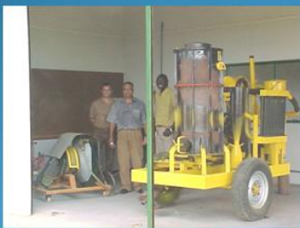
Unidade de gaseificação
